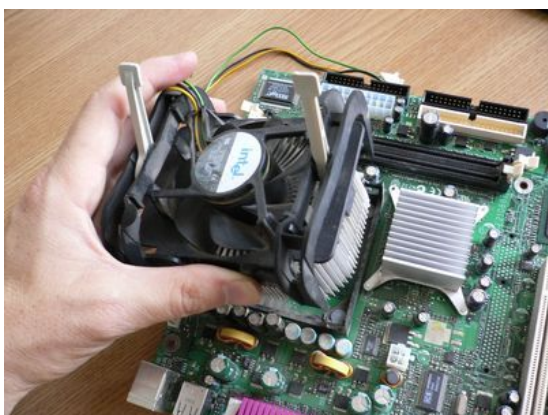
Figura 2.2.2 Instalarea sistemului de răcire a procesorului
