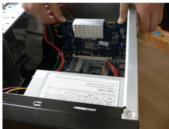
Figura 2.4 Instalare placă grafică
