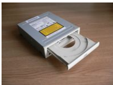
Figura 1.8.3 Unitate optică internă și externă
