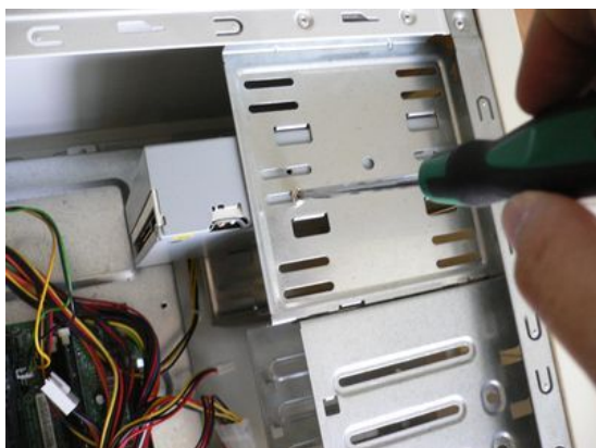
Figura 2.3 Instalarea unității optice și a hard disk-ului
