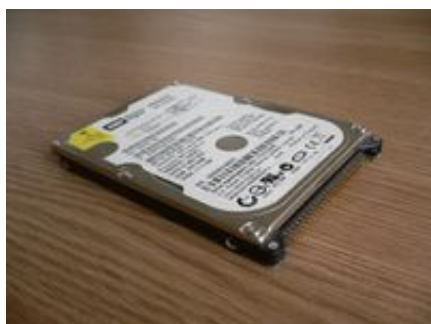
Figura 1.9.3 Unități de stocare utilizate la Laptopuri
