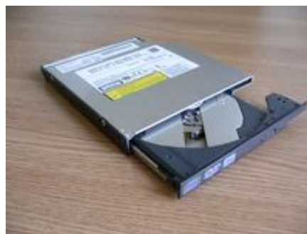
Figura 1.9.3 Unități de stocare utilizate la Laptopuri
