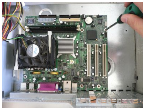
Figura 2.2.4.1 Instalarea plăcii de bază în carcasă
