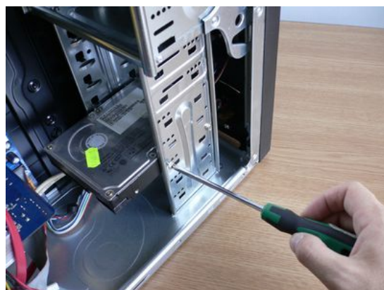
Figura 2.3 Instalarea unității optice și a hard disk-ului
