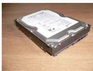
Figura 1.8.2 Unitate Hard Disk
