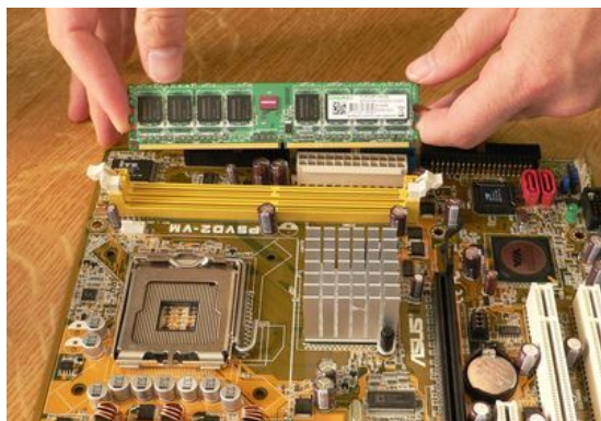
Figura 2.2.3 Instalarea memoriei pe placa de bază
