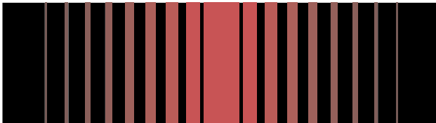
Fig. III. Difracția luminii de la o fantă îngustă. Observați deosebirea tabloului de difracție de cel de interferență (fig. I): la difracție lățimea franjelor și distanța dintre ele sunt variabile, iar la interferență ambele sunt constante.
